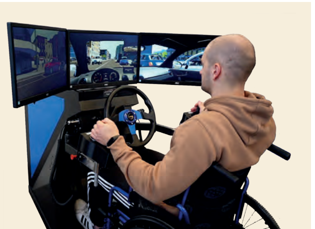
Il simulatore SIDA per disabili è programmato per fare diversi test di abilità alla guida, utili sia per le CML che per i centri riabilitativi
